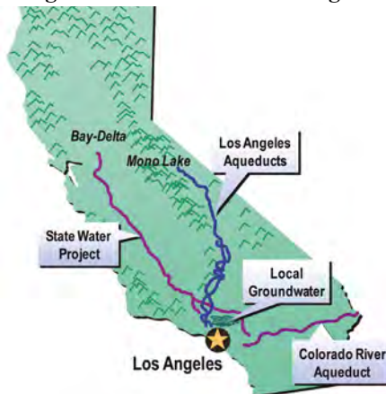
Figura 2. Principales fuentes de abastecimiento de agua de la Ciudad de Los Ángeles
