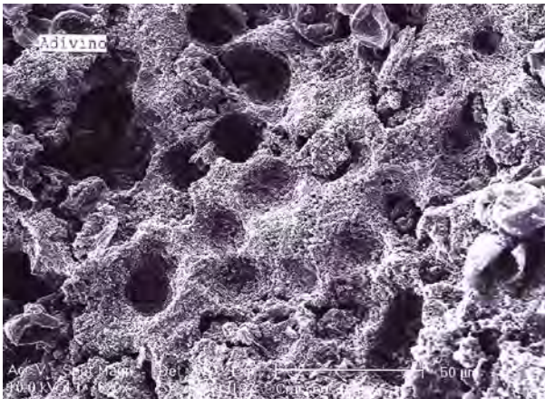
Figura 3. Biodeterioro microbiano en forma de micropozos que se desarrollan debajo de biopelículas dominadas por poblaciones cianobacterianas que penetran el substratos probablemente producto del exudado de ácidos orgánicos (Ortega-Morales et al. , 2000).
