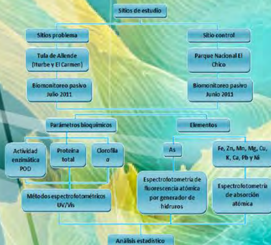
Figura 1. Diagrama del diseño experimental de la exposición del biomonitor a contaminantes atmosféricos.
