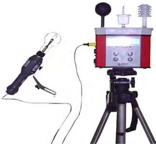
Figura 1: Monitor de estrés térmico y anemómetro omnidireccional, modelo QUESTemp 36
