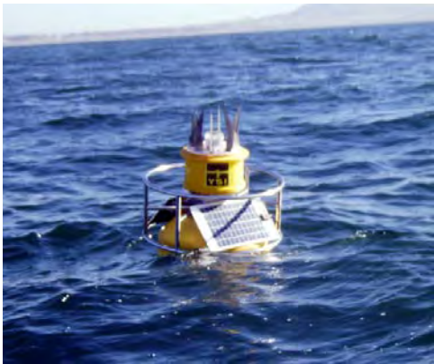
Fig. 3: Boya oceanográfica instalada para el monitoreo continuo.
