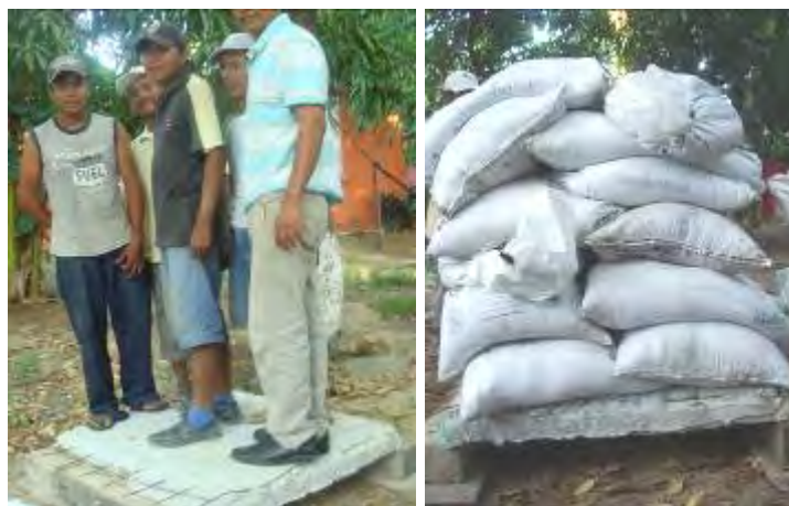
Figura 12: Prueba para la Capacidad de Carga.
