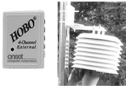
Figura 5. Equipo de registro térmico continuo, de la familia HOBO 8. Fuente: Trabajo de Campo.
