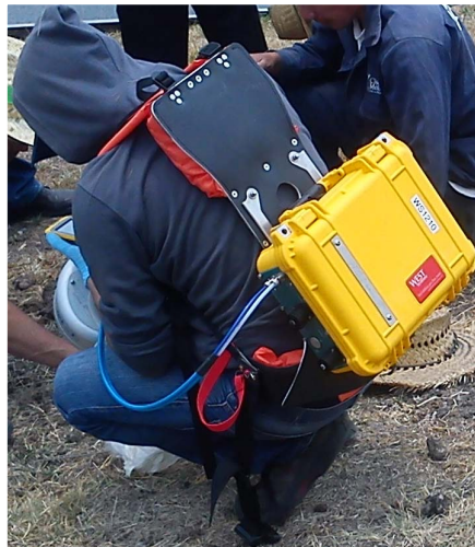
Figura 6. Mediciones con el equipo WEST en zonas donde apreciaban grietas.
