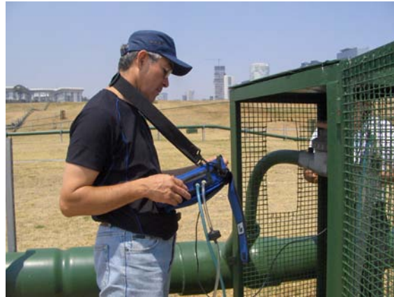
Figura 5. Mediciones de la composición y flujo del biogás en el pozo de extracción del SDF-PM utilizando un GEM 2000 Plus.
